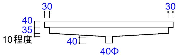
銅板落し 寸法 (断面図)
