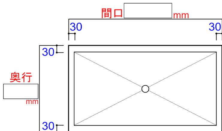
銅板落し 寸法 (平面図)
